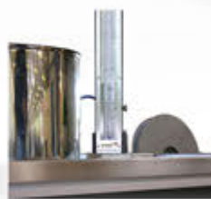
Устройство пузырькового теста
