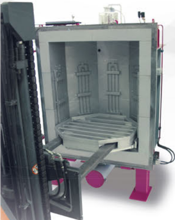
真空清洗炉 (VACUCLEAN) 1212 的处理室和装载托盘
