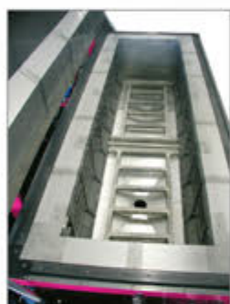
真空清洗炉 (VACUCLEAN) 254 的处理室
